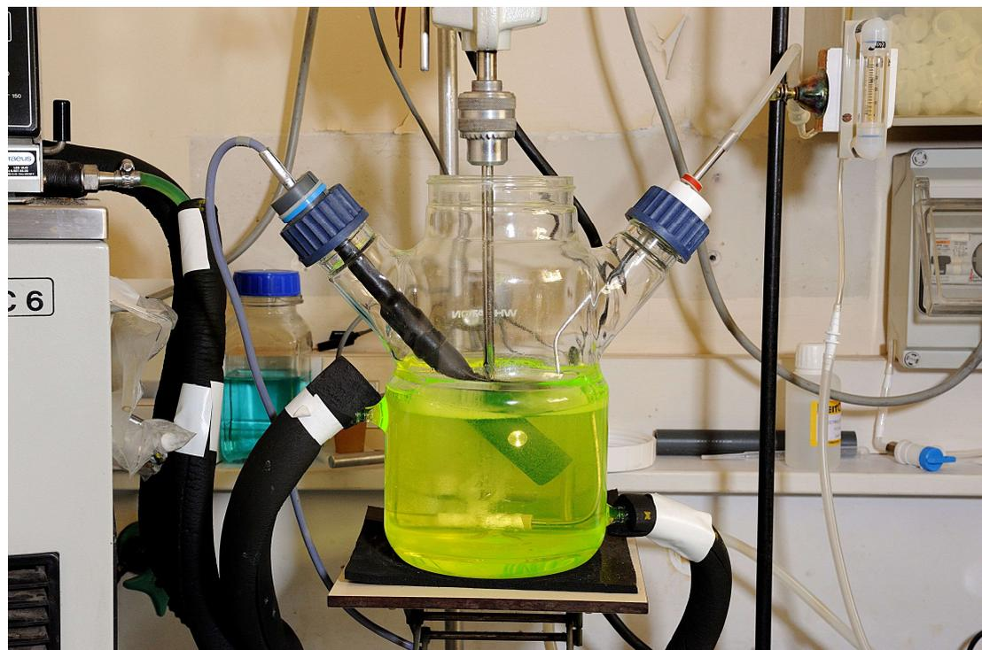
**Détermination du coefficient de transfert d'oxygène dans un bioréacteur (auteur : Sandrine Villain)**
