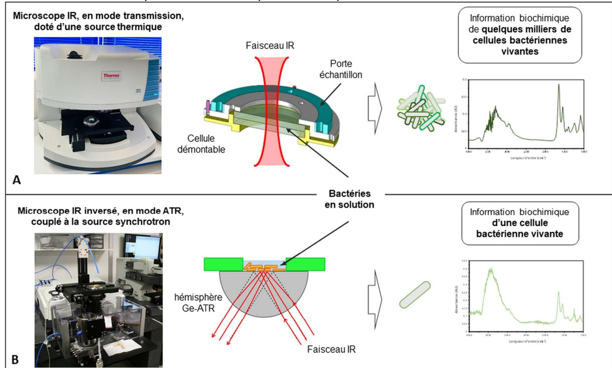
(A) Image du microscope infrarouge (IR) et représentation schématique de la cellule démontable, utilisés pour obtenir les spectres IR en mode transmission et permettre la caractérisation biochimique de quelques milliers de cellules bactériennes dans leur environnement aqueux.
