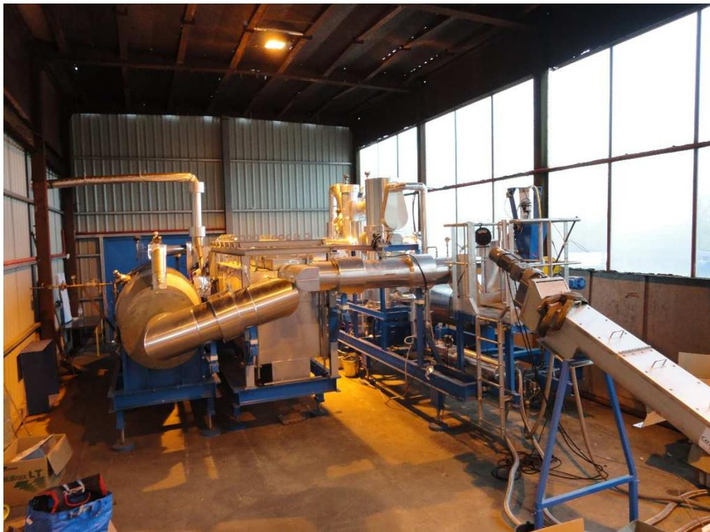
**Figure 2 : Représentation du démonstrateur de sécheur à tambour 3 passages par vapeur d'eau surchauffée**
